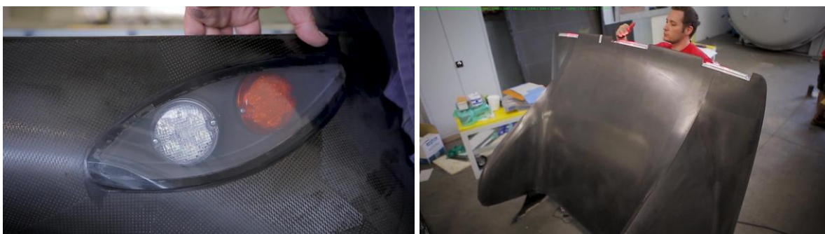
Sl. 114. Ugradnja i provera prednjih i zadnjih atestiranih optičkih svetlosnih grupa
