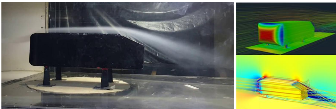
Sl. 9. Protok vazduha oko fizičkog modela Ahmedovog tela i kompjuterska 3D simulacija
