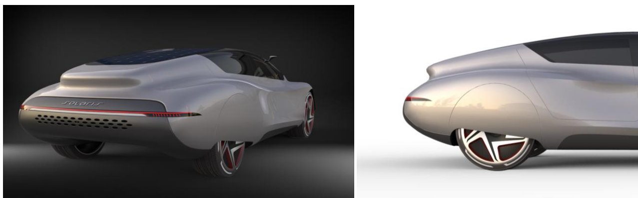
Sl. 148. Zadnji točkovi su namenski delimično prekriveni radi boljeg opstrujavanja vazduha
