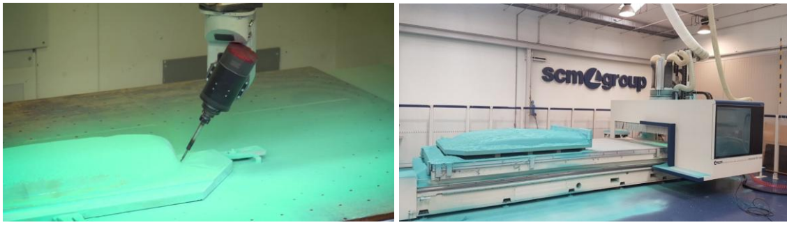
Sl. 104. Izrada fizičkog master modela na CNC mašinama u proizvodnim pogonima SCM group S.p.A.
