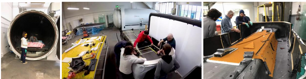
Sl. 106. Proces pečenja komada karoserije od karbonskih vlakana u specijalnoj pećnici autoklav i postavljanje panela od vatrootpornog nomeksa oko prostora za baterije i elektroinstalacije
