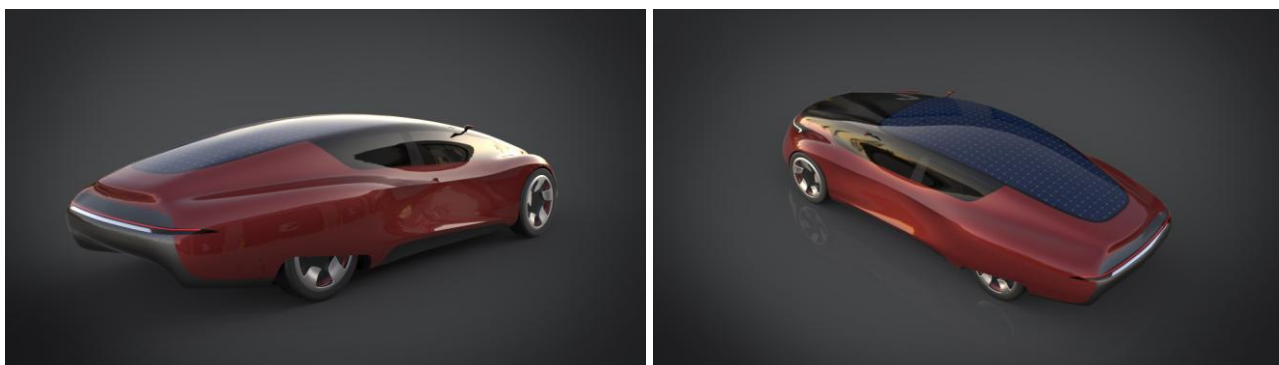
Sl. 141. Varijanta: veoma izdužen zadnji deo automobila po uzoru na NACA profil, sa vidljivim točkovima
