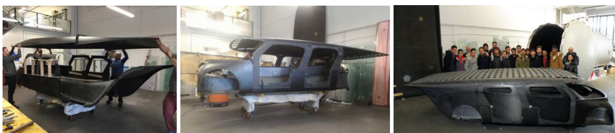
Sl. 109. Proveravanje sastava segmenta i unutrašnjih delova karoserije automobila i njihovo sklapanje
