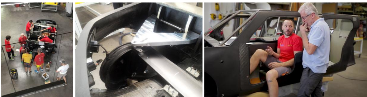
Sl. 113. Ugradnja zadnje osovine i uklapanje elektronike, sklop točka i testiranje nožnih komandi
