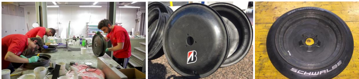
Sl. 107. Izrada felni točkova automobila od karbonskih vlakana
