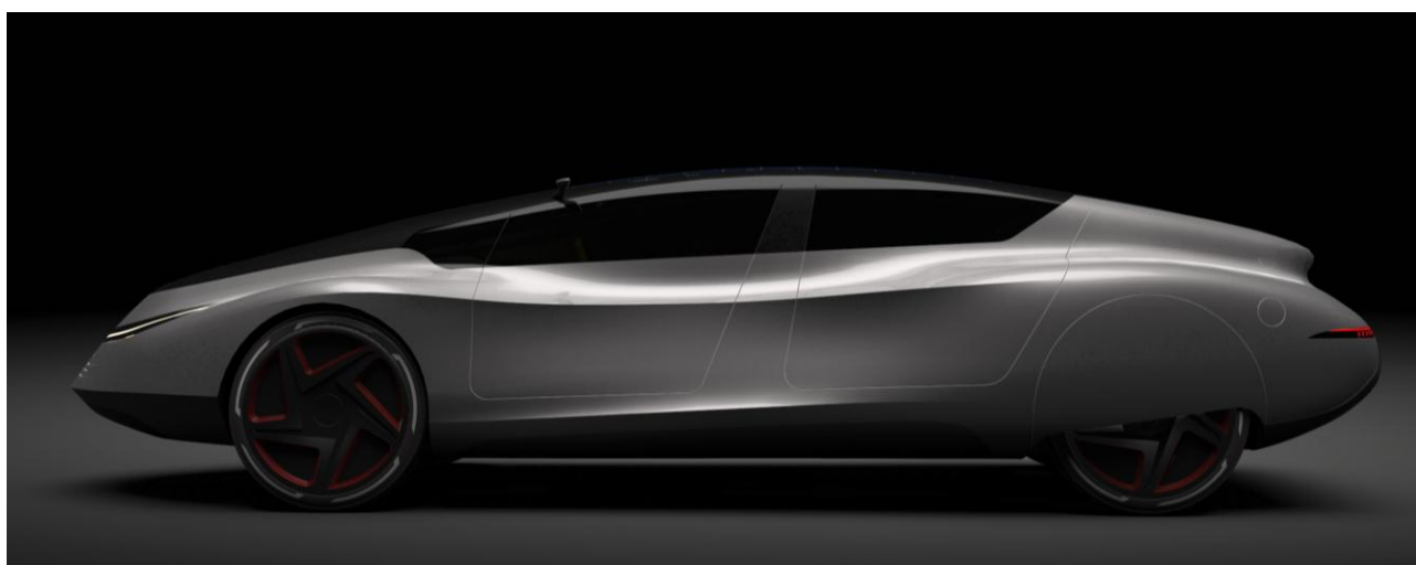
Sl. 164. Day Light Opening – efekat prepoznavanja karakteristične siluete, linija i kontura automobila
