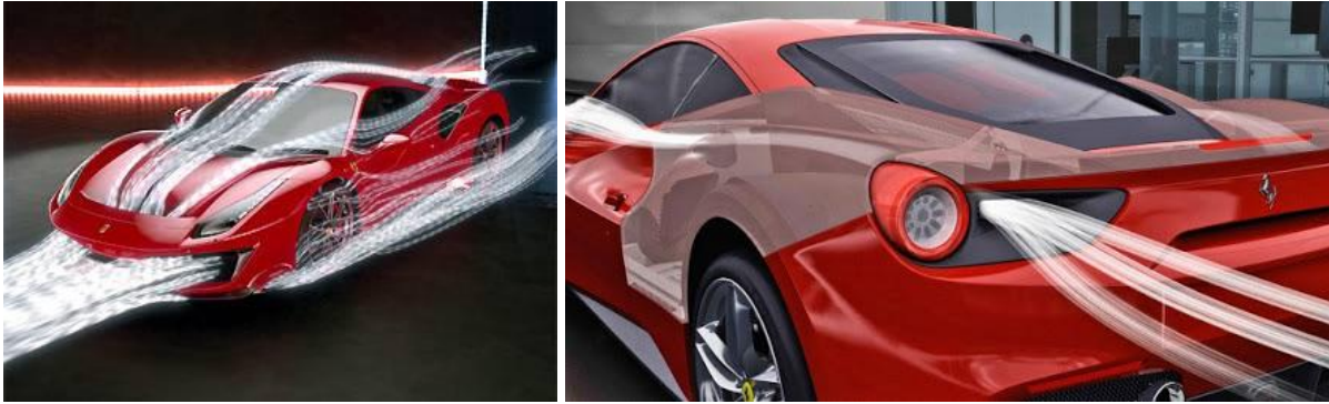
Sl. 22. Protok vazduha kroz karoseriju i oko karoserije kod različitih modela automobila Ferrari
