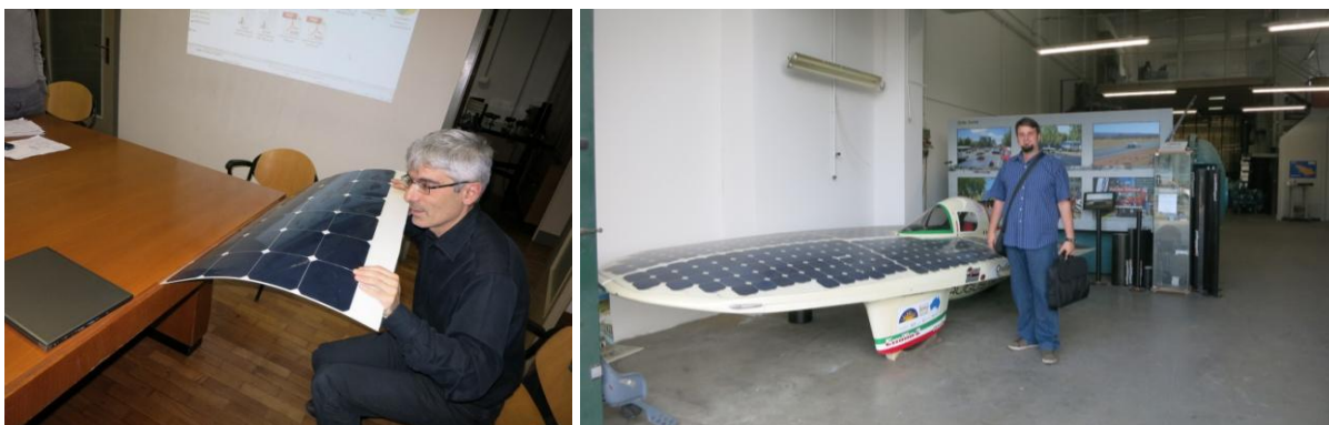
Sl. 43. Savitljivost solarnog panela Sl. 44. Zakrivljenje panela na automobilu u kategoriji Challenger
