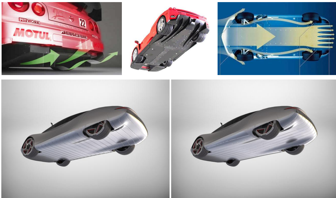
Sl. 147. Venturijev tunel u donjem delu karoserije stvara izlazno ubrzanje vazduha ispod vozila
