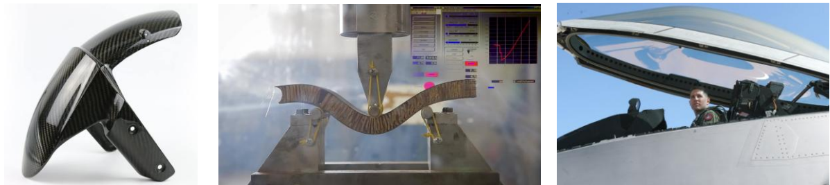
Sl. 101. a) Karbonska vlakna i kompozitni materijali; b) ploče od nomeksa sačaste strukture (visok stepen čvrstoće i savitljivosti); c) kupola avionske kabine urađena od prozirnih polikarbonatskih masa
