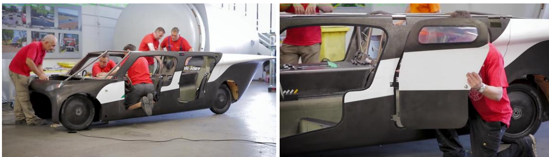
Sl. 116. Postavljanje laganih vrata od karbonskih vlakana na predviđene veze na B-stubu karoserije
