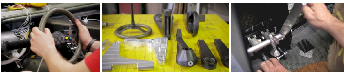
Sl. 108. Gruba konstrukcija volana sa komandama i mehanizam pedala gasa i kočnice od legure metala
