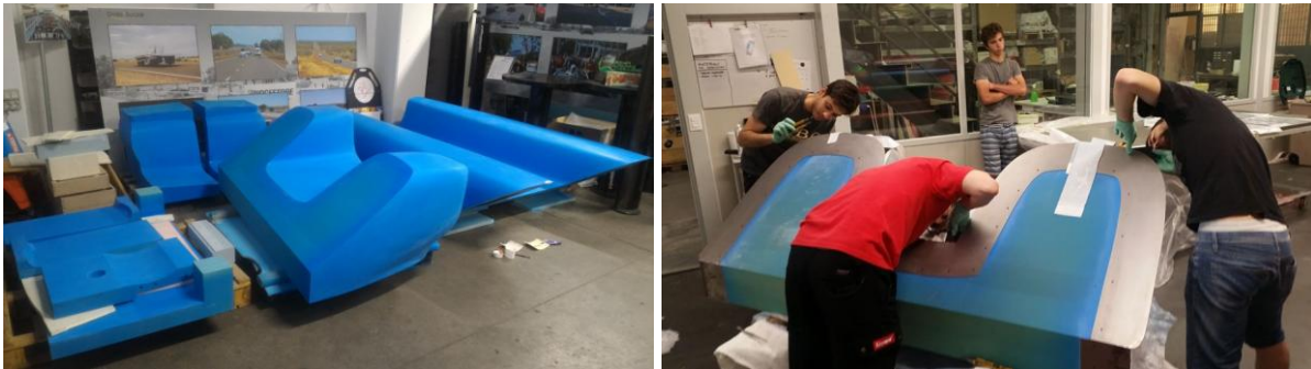
Sl. 105. Priprema i poliranje delova master modela za delove karoserije od karbonskih vlakana
