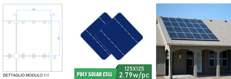
Sl. 41. Oblik i dimenzije osnovnog modula solarne ćelije
