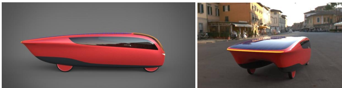
Sl. 68. Varijanta 2: svedena forma čeonu površine i bočne siluete po uzoru na NACA profil
