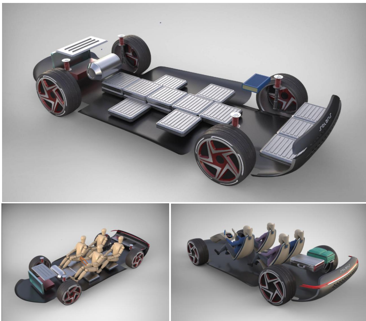
Sl. 155. Package automobila: a) pozicija pogonskog sistema – powertrain , baterija i konvertora; b) pozicija sedenja putnika; c) pozicija sedišta za putnike, sa prtljažnim prostorom u zadnjem delu automobila
