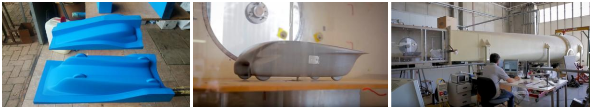
Sl. 100. a) Delovi master modela od veštačkog drveta ( epowood ) za izradu makete automobila; b) maketa automobila – služi za proveru aerodinamičnosti automobila i koeficijenta otpora vazduha; c) kompjuterska aerodinamička ispitivanja u vazдушnom tunelu pomoću makete automobila.
