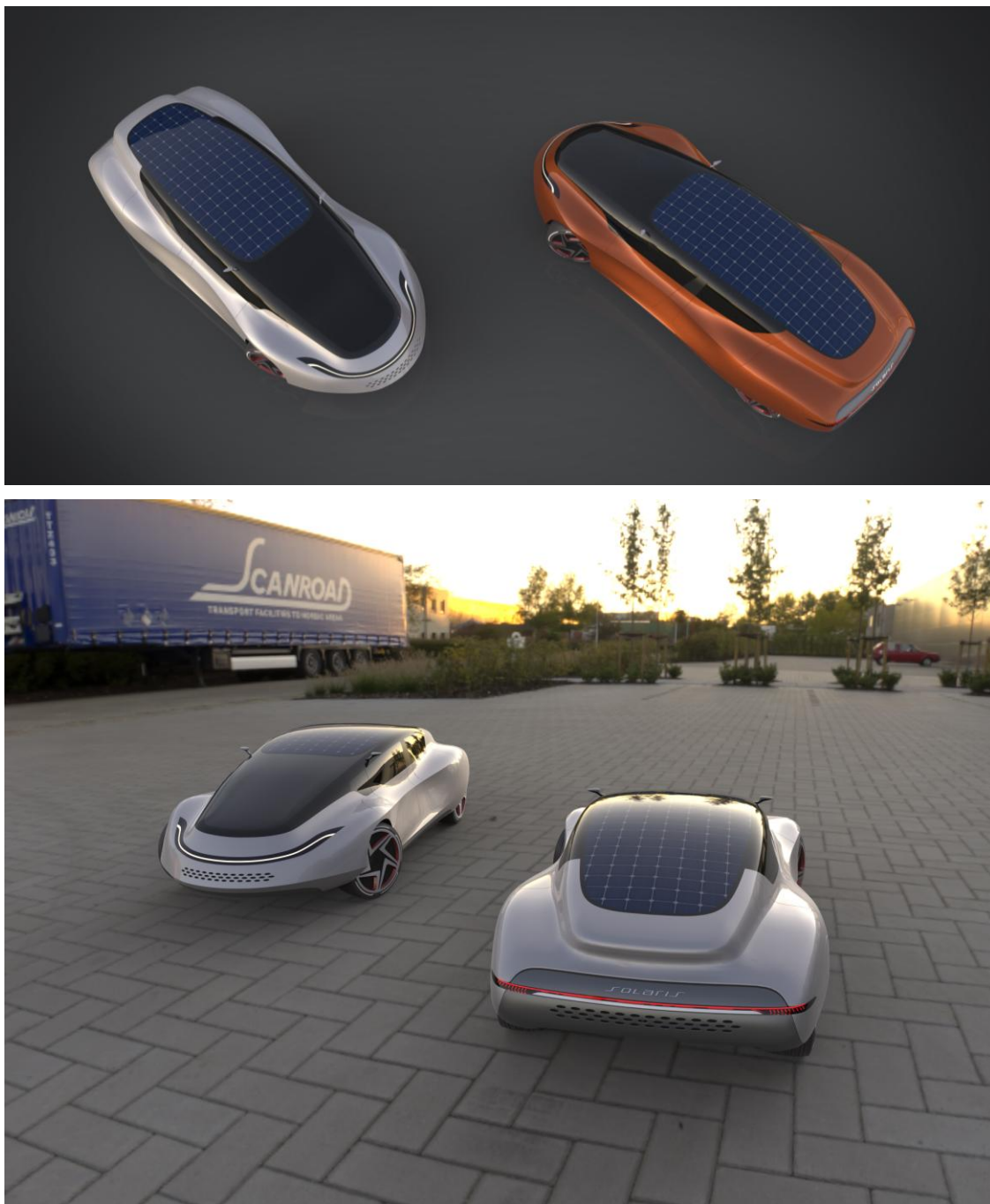
Sl. 160. Solarni paneli na krovnoj površini automobila za dopunjavanje električnih baterija
