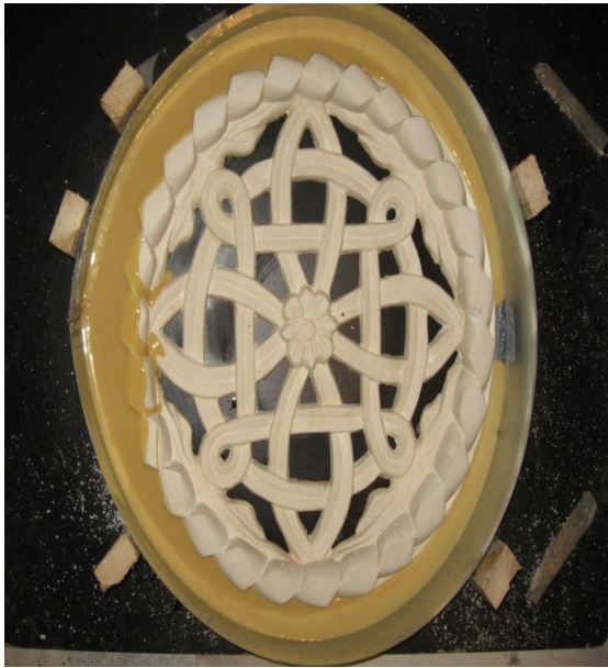
Слика 46. Калуп и почетак ливења у полиуретанској гуми
