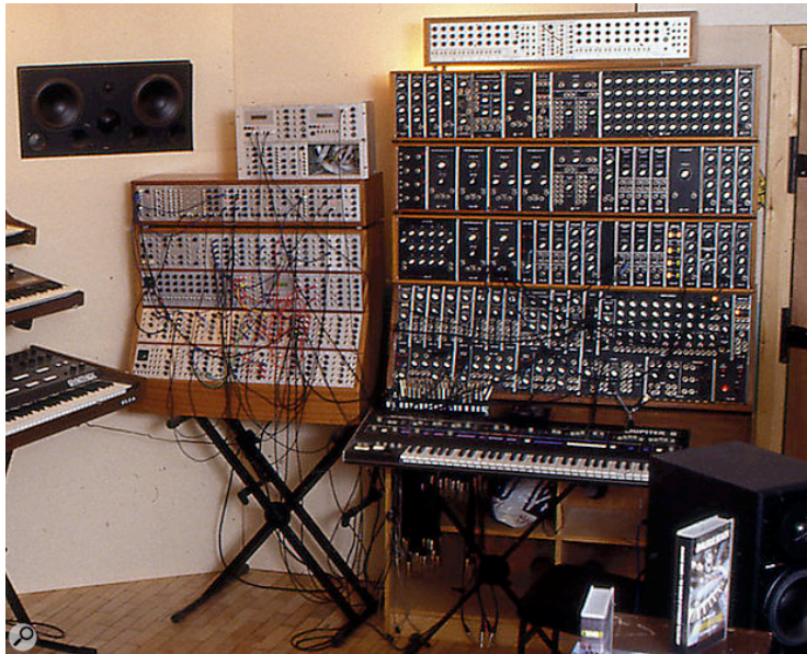
Пример 6: Moog System 55 (проширена верзија)
