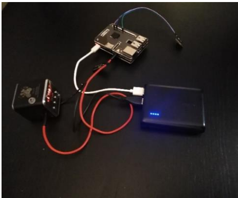
Слика 14. Кристина Јањић: Минијатурни компјутер Raspberry PI3 и сензор повезани са звучником
