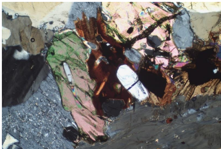
Прилог 5.3. Узорак T1/1 – Лабрадорит (варијетет габра) Величина фотографије: дужа страна 2 mm; николи укрштени
