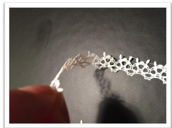
Сл. 58-61 горе лево: Генерисани модел бр 3 у Рајно софтверском програму, 100 x 100 mm, горе десно: детаљ, доле лево: ФДМ технологија, ПЛА филамент, 100 x 100 mm, доле десно: приказ флексибилности, 2014.
