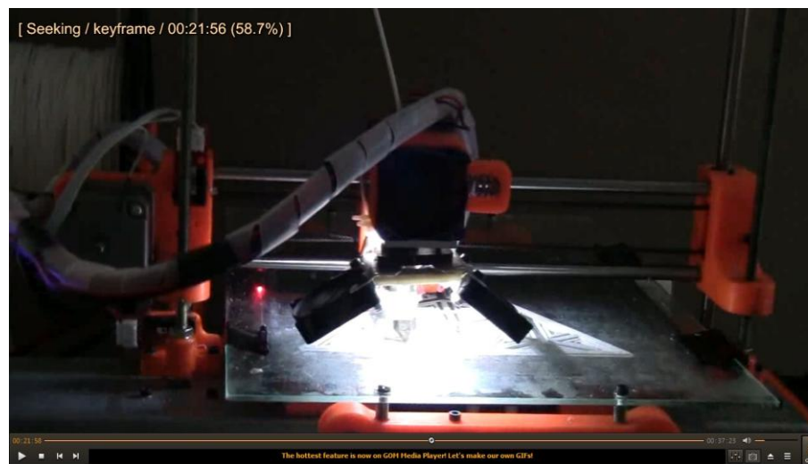
Сл. 41-42 лево: Произведен модел са грешком; десно: Производња модела на ФДМ машини
