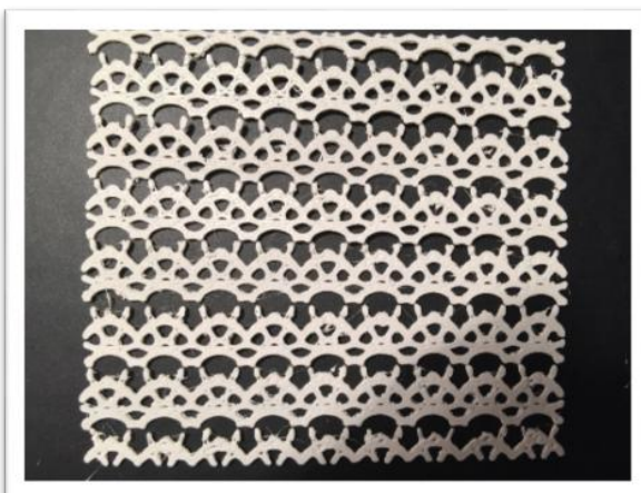
Сл. 58-61 горе лево: Генерисани модел бр 3 у Рајно софтверском програму, 100 x 100 mm, горе десно: детаљ, доле лево: ФДМ технологија, ПЛА филамент, 100 x 100 mm, доле десно: приказ флексибилности, 2014.
