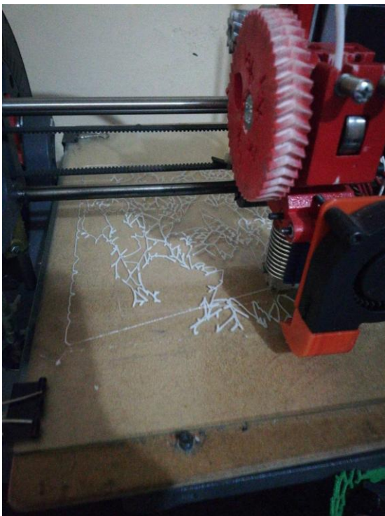
Сл.113-114 Реализација производње ФДМ технологија, стаклена радна плоча на коју је нанесен слој фиксир спреја, ТПУ филамент, 2018.
