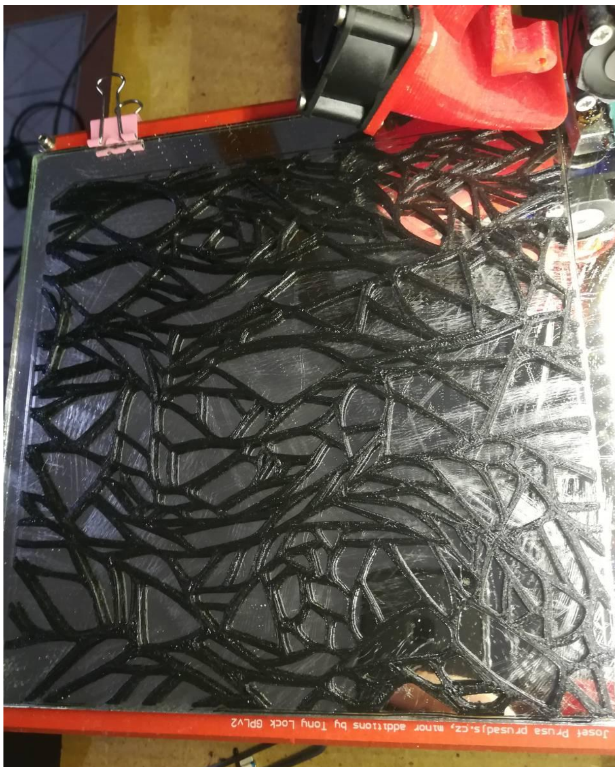
Сл.115 Реализација производње ФДМ технологија, стаклена радна плоча, ТПУ филамент, димензије 180 x 180 mm, 2018.
